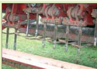
Aération décompaction, égalisation
